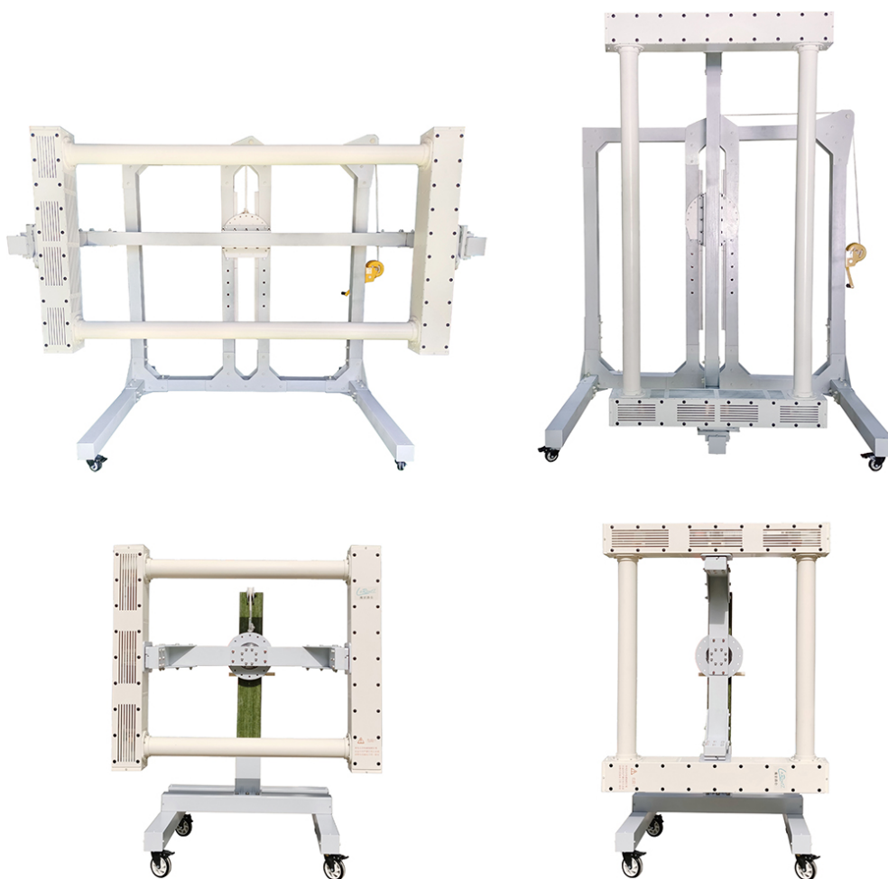
同比例下，LRET-10K100M-S1 与 LRET-10K100M-1（配极化旋转支架）对比（体积缩小 65%）
